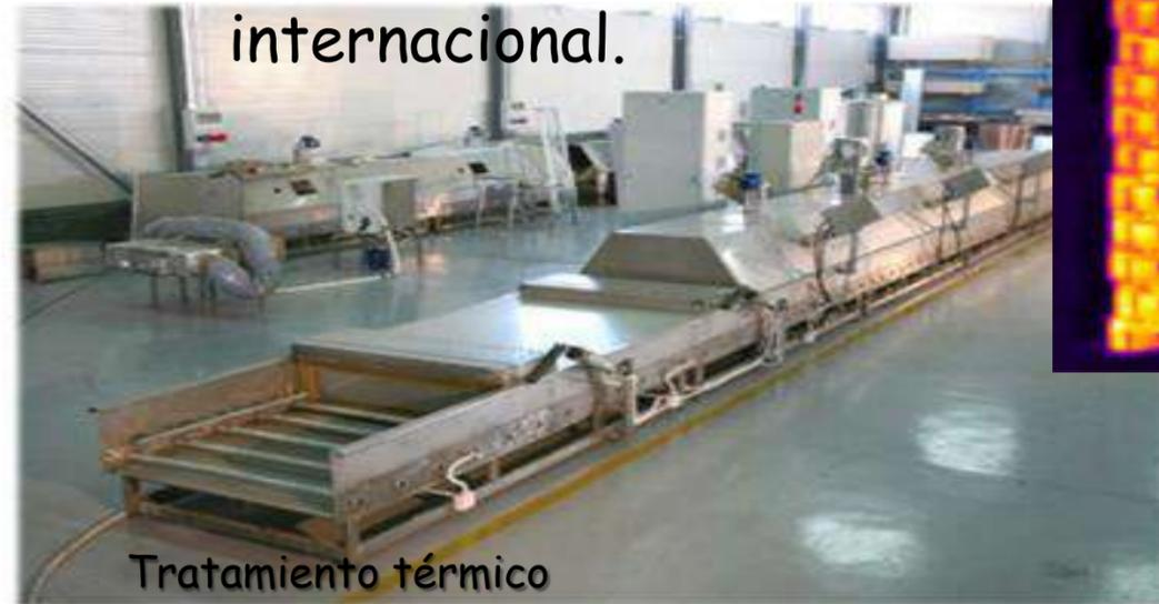
Tratamiento térmico mediante calentamiento dieléctrico.
